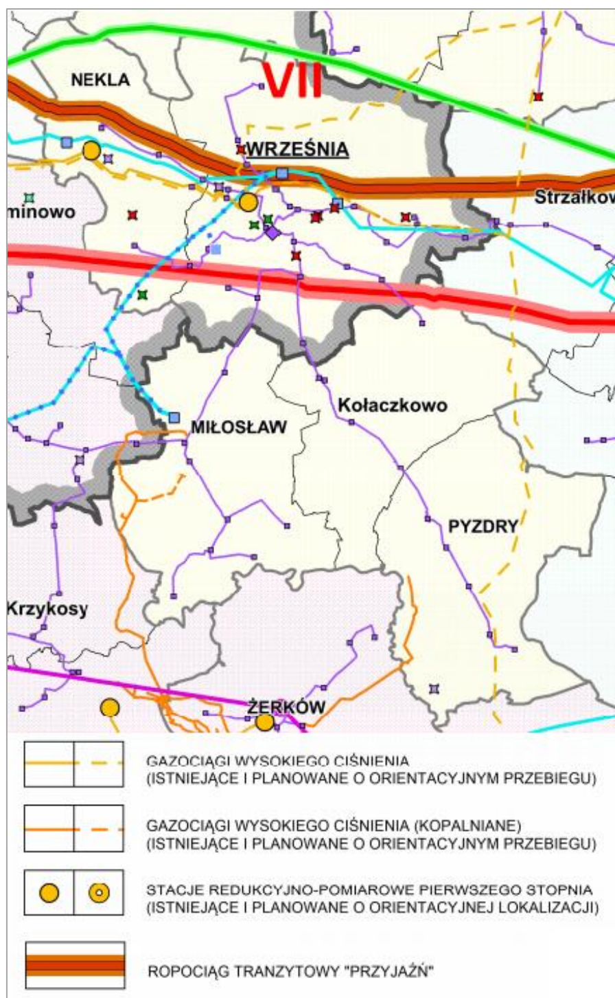
Rysunek 38. Przebieg gazociągów przesyłowych wysokiego ciśnienia oraz ropociągu tranzytowego przez teren Powiatu Wrzesińskiego
