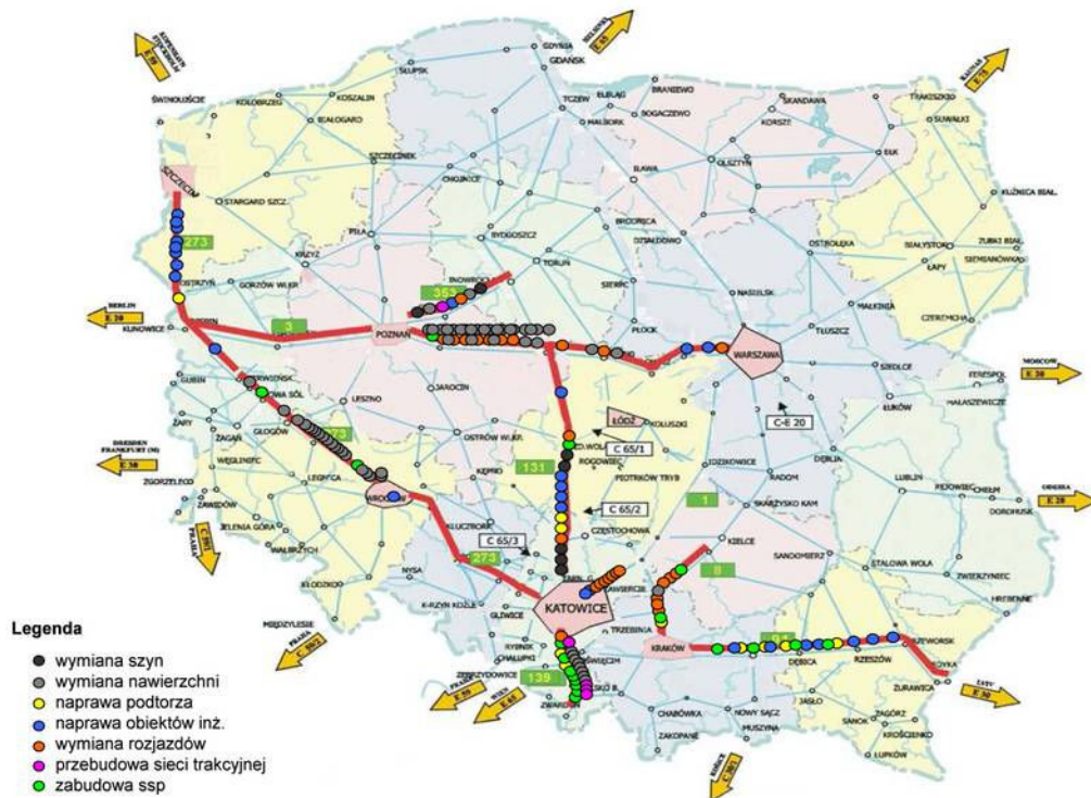
Rysunek 3 Plany modernizacji linii kolejowej
