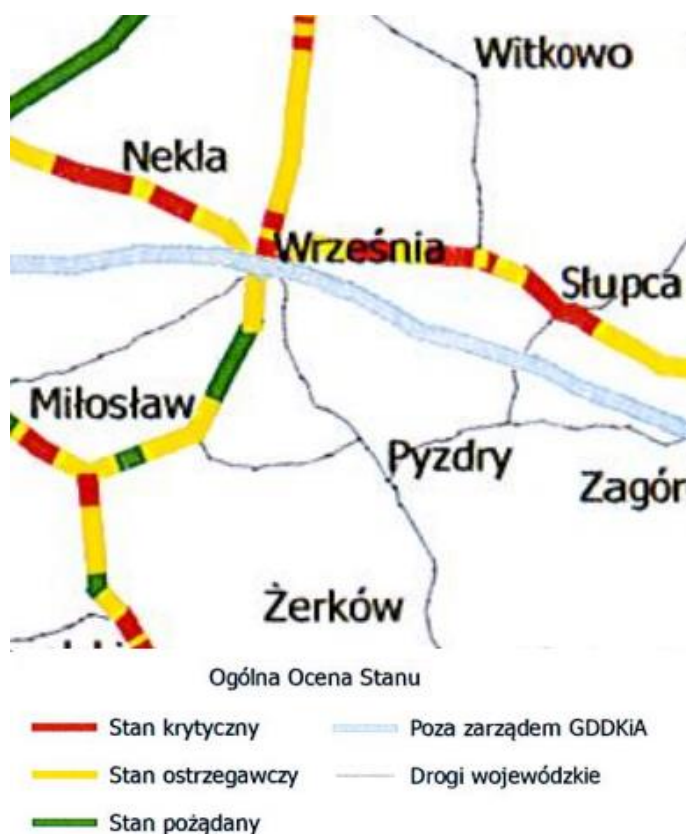
Ryc. 5. Stan techniczny dróg krajowych zarządzanych przez GDDKiA przebiegających przez obszar powiatu wrzesińskiego (na dzień 31.12.2016 r.)
